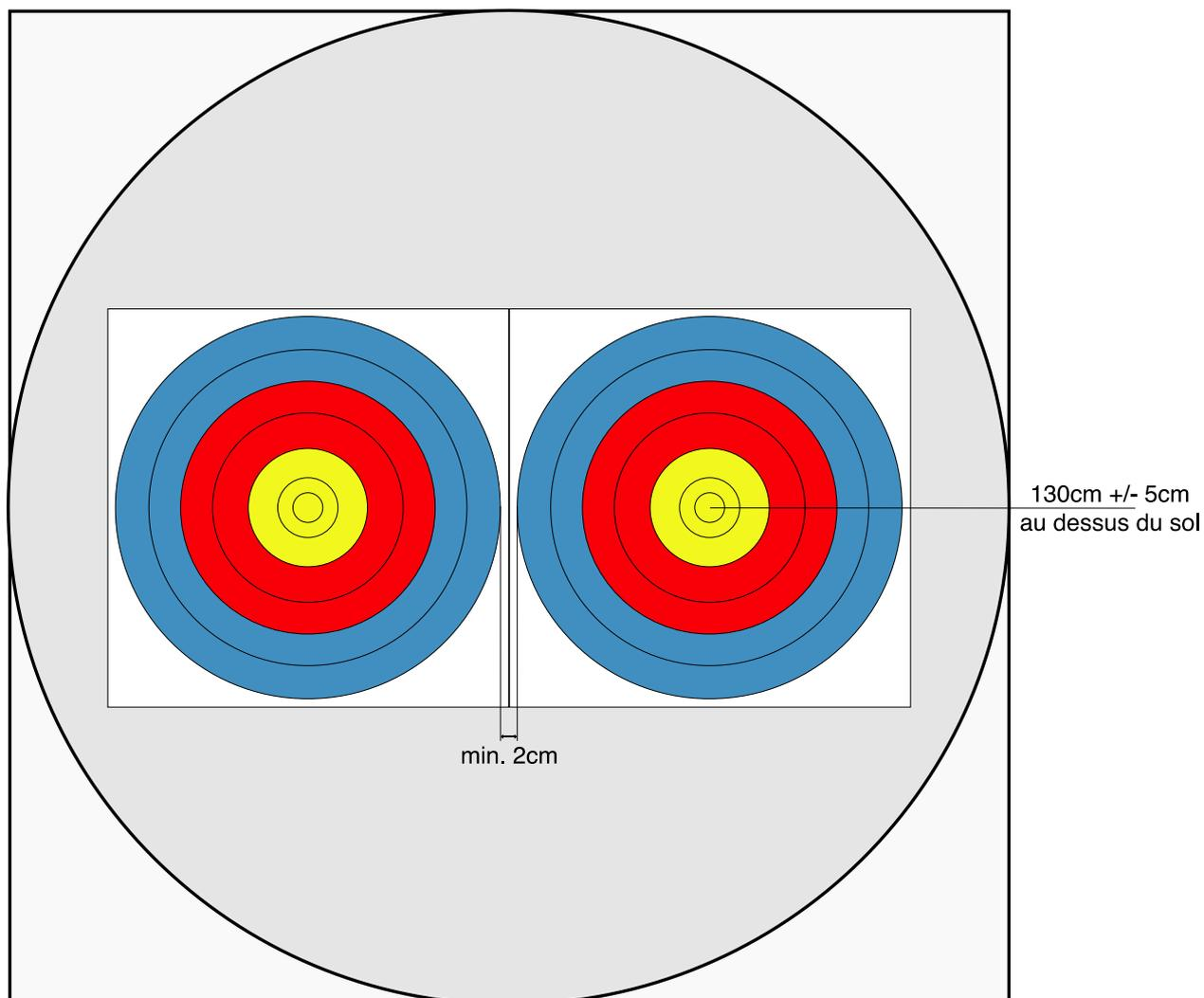
En cas de difficulté, l'organisateur et l'arbitre prendront les décisions permettant de respecter le matériel et la sécurité. Par exemple : éviter que la zone marquante soit en face d'un montant du chevalet si les flèches traversent les blasons. Dans ce cas l'écartement pourra être réduit à une valeur comprise entre 1 et 2 cm.
